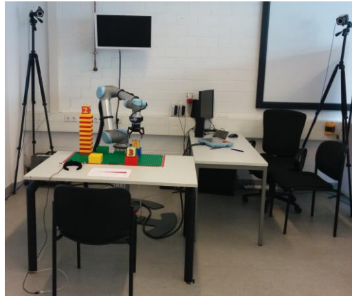
Abbildung 1: Versuchsaufbau, UR5-Roboter mit Greifer, Monitor, Haarreif mit IMU und Motion Capture Kameras.
