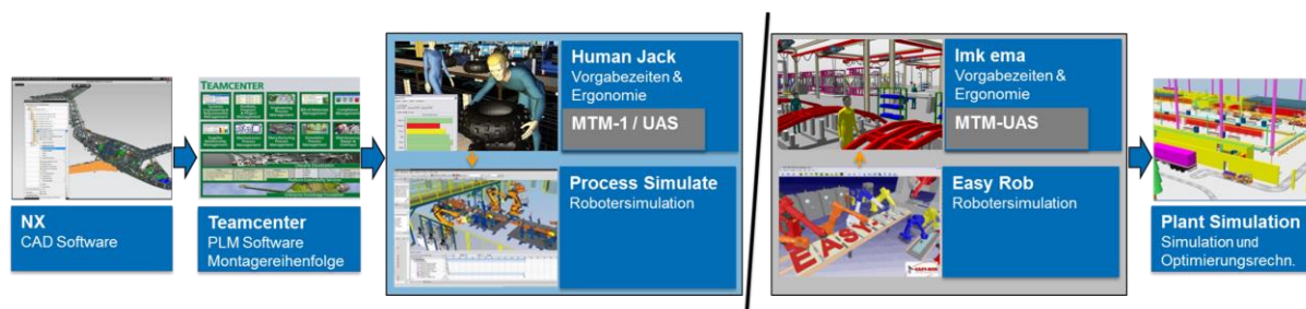
Abbildung 2: Tool Chain auf Basis von Siemens Tecnomatix
