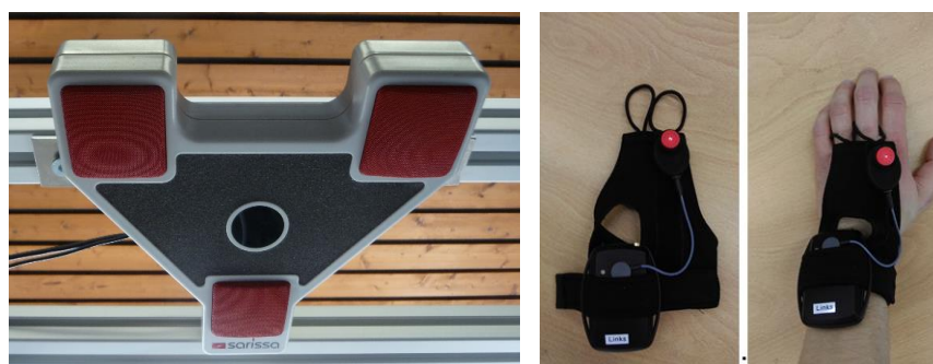
Abbildung 1: Bestandteile des LPS (Empfangseinheit und Ultraschallsender)
