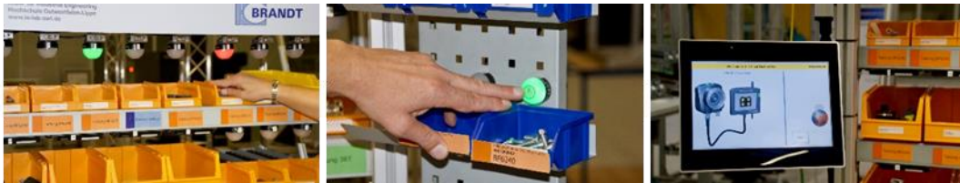
Abbildung 1: Bestandteile des PTL – Reflexionslichttaster, kapazitive Sensoren und 13,3 Zoll Touch-Display
