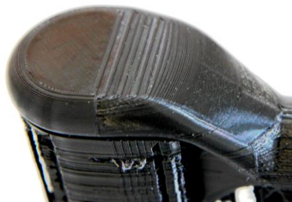
Abbildung 1: Stufeneffekt bei FDM-Verfahren am Rollatorhandgriff
