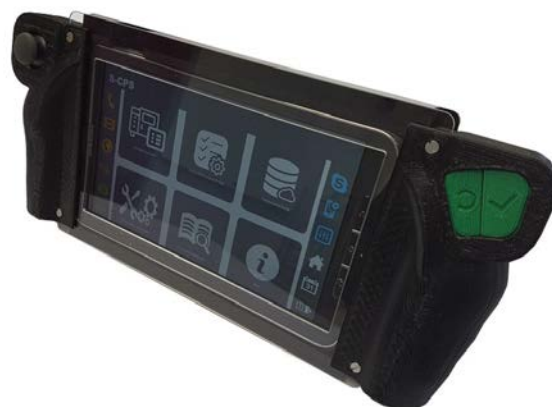
Abbildung 5: Funktionsfähiger Low-Cost-Prototyp eines mobilen Assistenzsystems für Instandhalter
