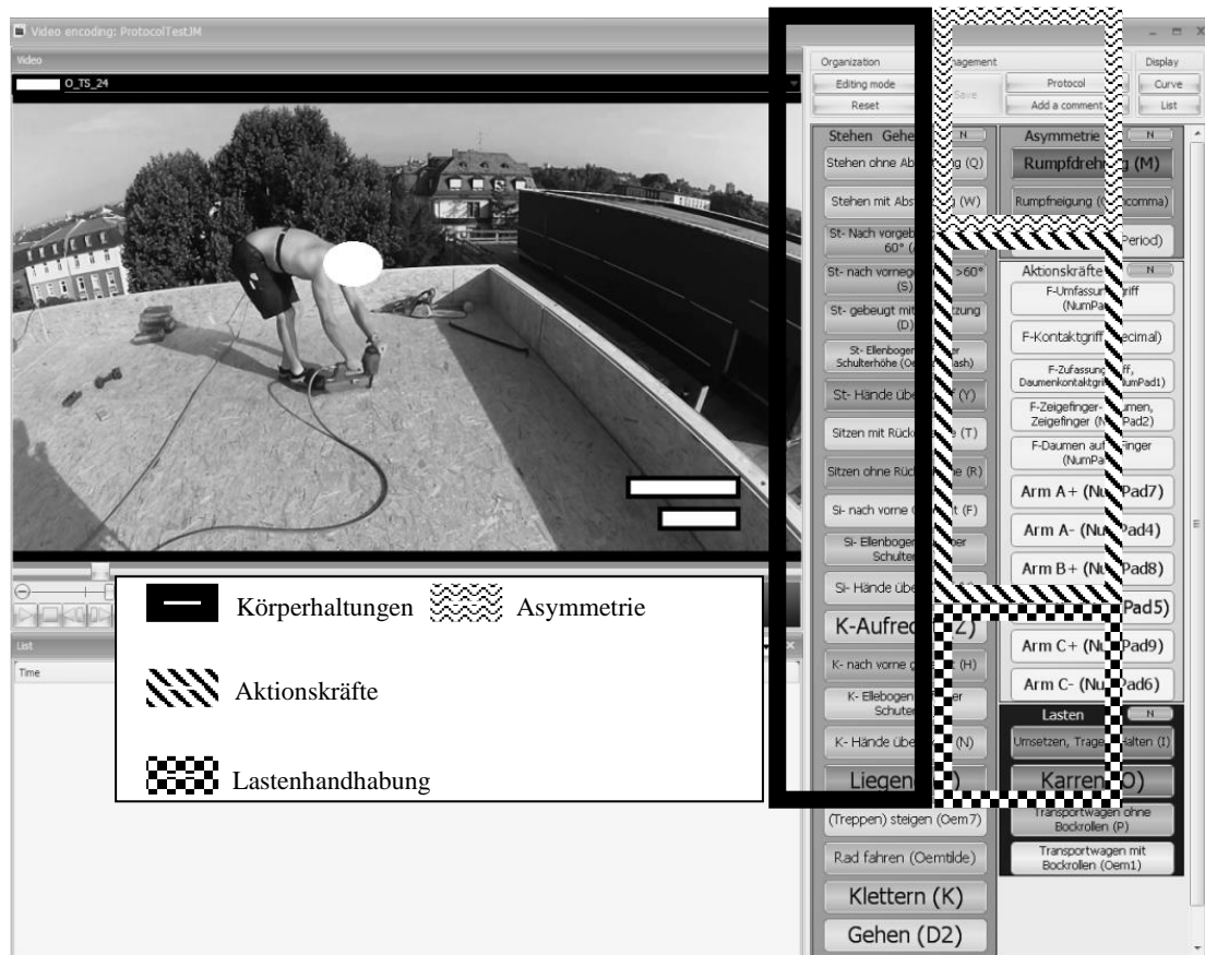
Abbildung 1: Auswertung der Videoanalyse der Baustellen mithilfe des Programms Captiv
