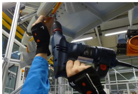
Abbildung 4: Belastungsfeedback während der Montage einer Rumpfschale: Inertialsensoren im Sensorhandschuh erfassen die Arbeitsschritte und berechnen zulässige Körperkräfte
