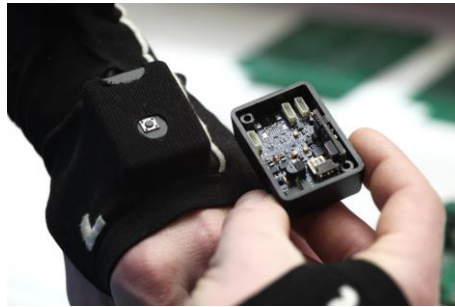
Abbildung 1: Miniaturisiertes Inertialsensormodul des Fraunhofer IFF in Magdeburg für die referenzlose Erfassung von Bewegungsdaten während der Montage
